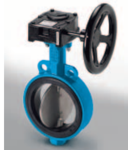
Тип KG 2 [Ду 50 - Ду 500] Межфланцевая заслонка для монтажа между фланцами DIN EN 1092-1, Ру 10/16, ANSI 150.
