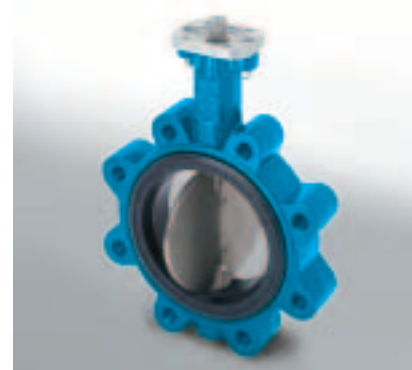
Тип KG 4 [Ду 50 - Ду 500] Заслонка lug type, может присоединяться с одной стороны, для монтажа между фланцами DIN EN 1092-1, Ру 10/16, ANSI 150.
